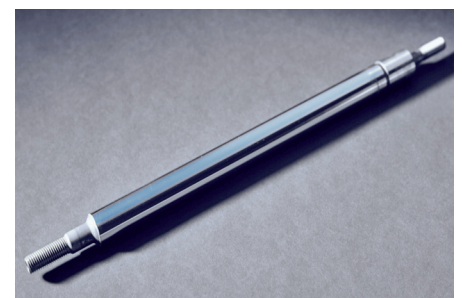
Abb. 1: Anlage zur Maßverchromung mit hoher Geschwindigkeit (li.) und verchromte Kolbenstange (re.)
