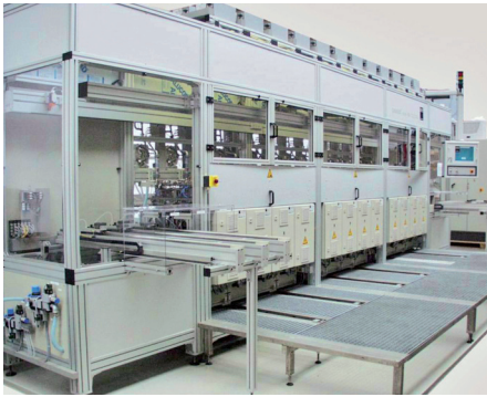
Abb. 5: Vollautomatische Anlage zum Harteloxieren (links), oberflächen behandelter Zylinder und Querschliff durch eine Oxidschicht (rechts)
