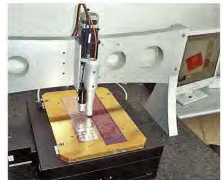
Abb. 3: Rautiefenmessung mittels Weißlichtinterferometer
