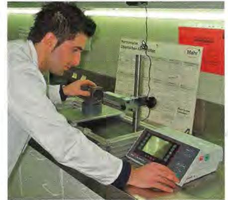
Abb. 2: Rautiefenmessung mittels Perthometer
