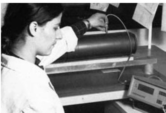
Schichtdickenmessung von einem GLIDECOAT-beschichteten Hydraulikzylinder. Vorgabe: 15 \pm 3 \mu\text{m} ; mit ausgedrucktem Messprotokoll.
