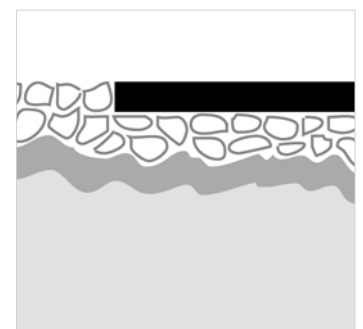
■ GLIDECOAT-Beschichtung ca. 15 µm nach Belastung □ Dispersionsschicht ■ Base-Coating
