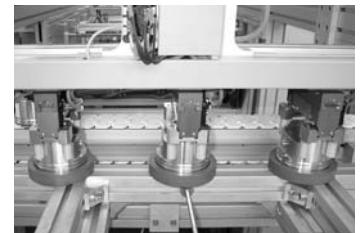
Automatisches Handlingsystem zur Bestückung und Entnahme der Beschichtungszellen
